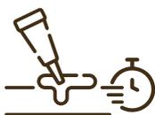
É o máximo intervalo de tempo, que se pode esperar, desde a aplicação da cola e ainda se obter uma boa colagem. Este fator depende do tipo da cola, da natureza do substrato bem como, das condições ambientais.
